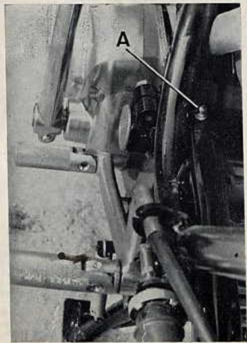
Pour avoir accès au graisseur (A) de l'axe du bras oscillant arrière, déposer le couvercle du coffre à outils côté gauche (photo R.M.T.)
