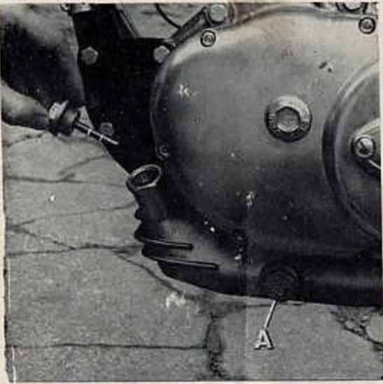
Le bouchon de remplissage est muni d'une courte jauge. Il faut visser complètement ce bouchon pour contrôler le niveau qui doit se trouver entre les deux repères, la machine devant être sur un plan bien horizontal A. Bouchon de vidange (photo R.M.T.)
